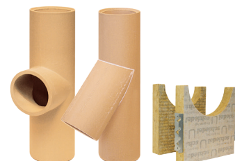
8 Ümar liitelement 90° ja 45° Kõrgus: 660 mm. Läbiviiguava sisemõõt võrdne lõõriavaga, va. 120 mm toru (liiteava 140 mm). Isolatsioon liitelemendile + kinnitused.
