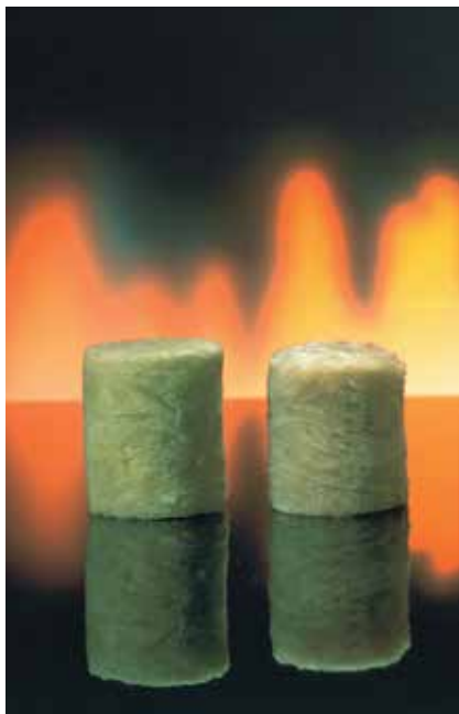
PAROC kivivill peab vastu väga kõrgetele temperatuuridele. Pildil näete PAROC kivivilla näidist enne ja pärast EN ISO 1182 süttimatuse katse läbiviimist. Antud testis kuumutati kivivilla temperatuuril 750 °C.
