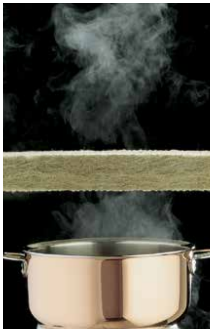
Tänu kivivilla hingavale ja õhku läbilaskvale struktuurile saab niiskus sellest õigesti ehitatud konstruktsioonist kiiresti välja aurustuda.
