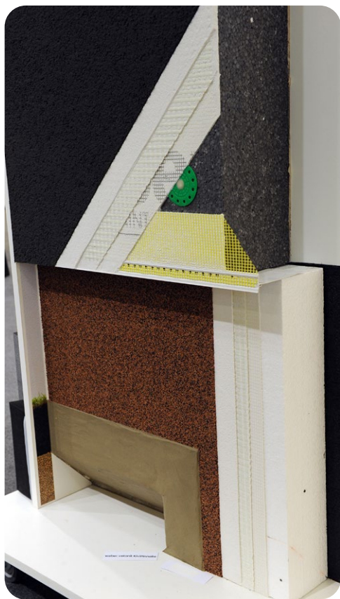
Näide õigesti ehitatud hoone soklist ja fassaadist.
