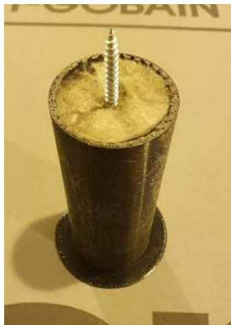
Termofix - puks + kinnituskruvi Puks puuritakse soojustusplaati, soojustus jääb puksi sisse.
